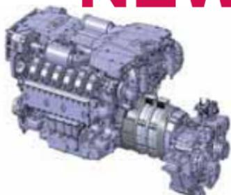
A seconda della configurazione, si potranno selezionare varie modalità di funzionamento, passando dalla propulsione tradizionale (Diesel) alla propulsione esclusivamente elettrica, oppure alla modalità "Eco" (un asse in propulsione Diesel e un asse in propulsione elettrica), o alla modalità "Full Power" con i motori elettrici in modalità power boost (Diesel + elettrico) per migliori performance.
